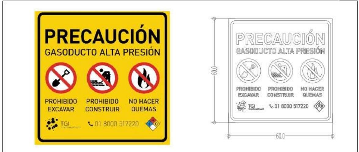
Ilustración 6. Señal terrestre para cruce con el derecho de vía (tablero inferior).
